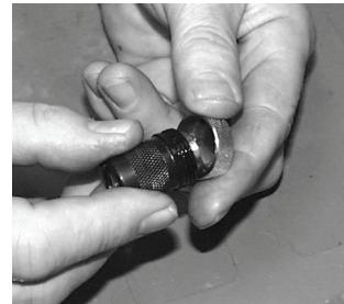
5. Prüfkopf mit Folie auf eine glatte Oberfläche aufpressen, damit eventuelle Luftblasen entweichen können und das Koppelmittel flächig verteilt wird. Mit aufgesetztem Prüfkopf Halterung fest andrehen.
